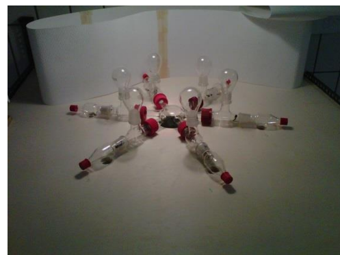
Imagen 12: cámara central y brazos del olfactómetro
