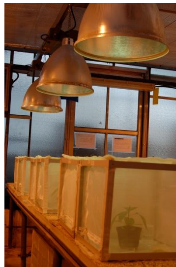
Imagen 16: Jaulones con malla Bionet y estándar bajo focos de espectro solar
